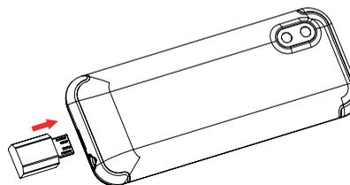
Заряжать батарею можно с помощью зарядного устройства.
